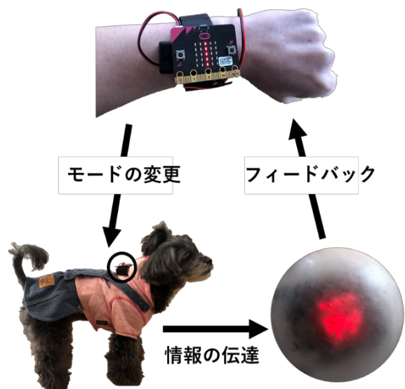
図1 本システムの通信の流れ
