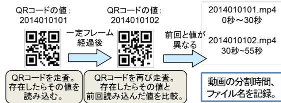
図 3 QR コードの認識処理の概要
