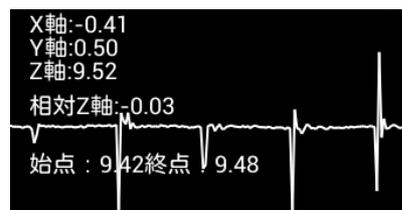
図 2 タッチ判定におけるZ軸加速度の波形
