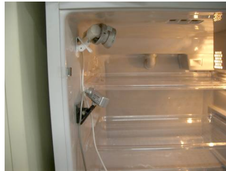
図2 WEBカメラ設置
