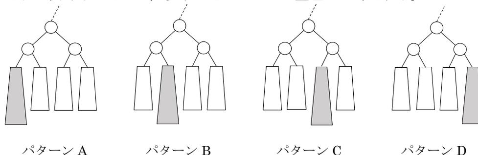
下記は、ノード  $n$  の左右の枝の先の長さ ( $n.left$  および  $n.right$  の部分木の高さ) が 2 以上離れたときに、それを 1 以内に収めるために、どのように回転操作を組み合わせればよいか説明した疑似コードである。適切に選択枝を選び、上の 4 パターンがそれぞれどのように処理されるか図示せよ。
